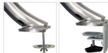
Tischklemme und Schraubplatte. Die Tischklemme lässt sich an Tischplatten mit einer Stärke von bis zu 66 mm (2,6") befestigen. Die Befestigung für die Kabeldurchführung passt in Bohrungen mit einem Durchmesser von 8–51 mm (.3–2") und einer Stärke von 80 mm (3").
