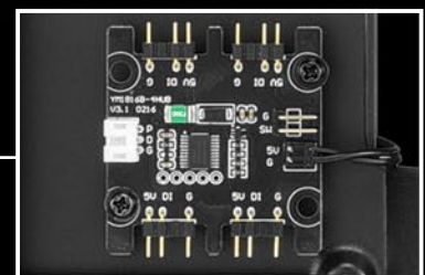
RGB-Steuerung für bis zu vier adressierbare LED-Elemente
