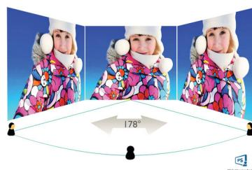
IPS-Monitore verwenden eine fortschrittliche Technologie, die für einen besonders großen Blickwinkel von 178/178 Grad sorgt und es ermöglicht, Inhalte auf dem Monitor aus nahezu jedem Winkel zu sehen! Im Gegensatz zur standardmäßigen TN-Technologie erhalten Sie mit IPS herausragend scharfe Bilder mit lebendigen Farben. Dadurch eignet sich die Technologie nicht nur ideal für Fotos, Filme
