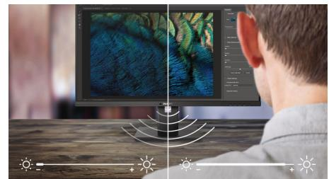
PowerSensor ist ein integrierter Sensor, der durch das Aussenden und Empfangen unbedenklicher Infrarotsignale erkennt, ob sich der Benutzer in der Nähe des Geräts aufhält, und automatisch die Bildschirmhelligkeit reduziert, wenn der Benutzer sich vom Schreibtisch entfernt. So wird der Energieverbrauch um bis zu 80 % gesenkt und die Monitorlebensdauer verlängert.
