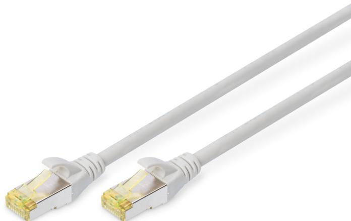
**CAT 6A S-FTP Patchkabel, Cu, LSZH AWG 26/7, Länge 20 m, Farbe Grau**
