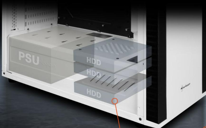
Zusätzliche Befestigungsmöglichkeit auf dem Gehäuseboden
