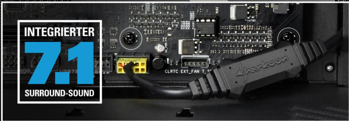
Die Gehäusevariante M25-W bietet als besonderes Feature eine integrierte Soundkarte, die bequem über USB auf dem Mainboard angeschlossen werden kann.
