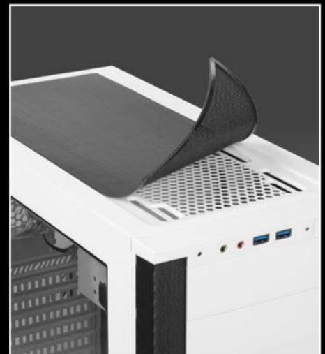
Staubfilter mit Magnethalterung
