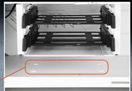
Das Netzteil sowie bis zu drei 3,5-Zoll-Festplatten lassen sich entkoppelt in einem Tunnel in der Unterseite des Gehäuses verbauen, um die Optik nicht zu beeinträchtigen.
