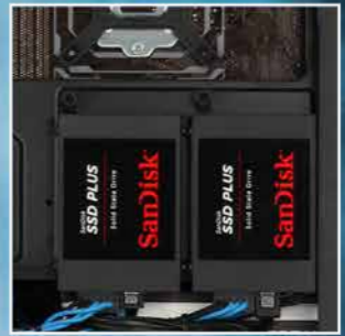
Halterungen für bis zu zwei 2,5-Zoll-Festplatten/SSDs
