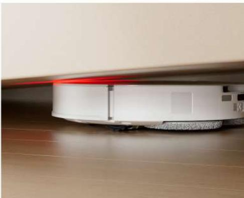
Der **obere Kontaktensor** erkennt Hindernisse über dem Kopf und verhindert so Kollisionen und Kratzer auf der Oberfläche für einen besseren Schutz.
