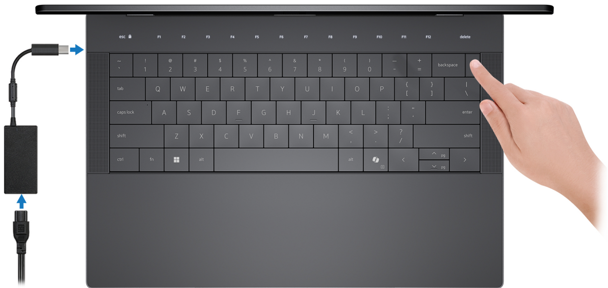
Abbildung 8. Schließen Sie das Netzteil an und drücken Sie den Betriebsschalter.
